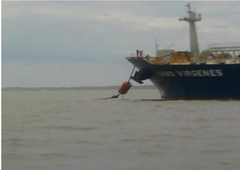
Ilustración 12. Luego que el sistema de amarre está abordo se hace firme la cadena al Stoper y queda amarrado el buque tanque.
