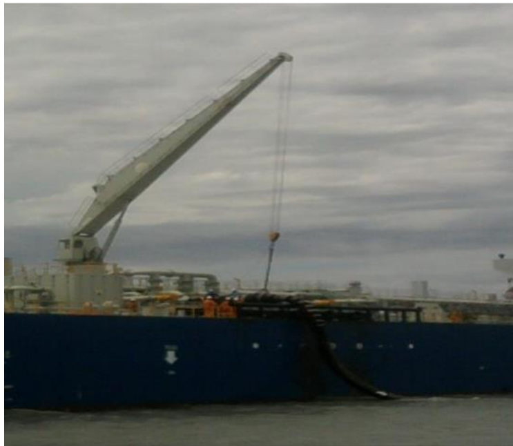
Ilustración 16. Luego de asegurar el cabezal a la brida del manifold del buque, la manguera se asegura con la eslinga tensada por la grúa donde quedará toda la operación.
