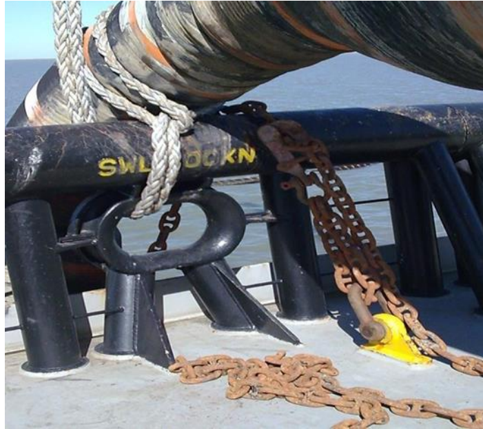
Ilustración 17. De esta manera se asegura el gancho disparador y queda firme la manguera al lomo de ballena.
