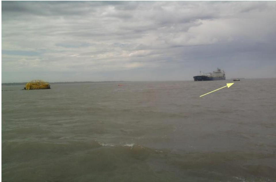
Ilustración 8. Lancha de apoyo toma el mensajero y lo lleva al buque.
