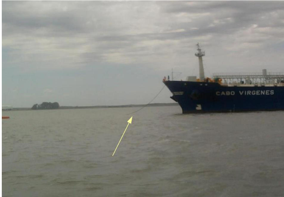
Ilustración 10. El buque comienza a virar solo el embando del mensajero.
