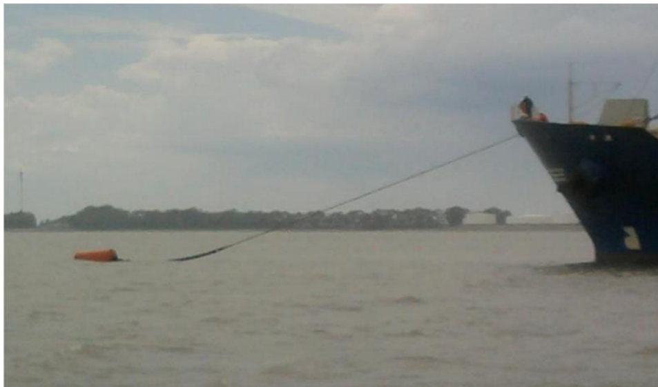
Ilustración 11. El buque continúa avanzando y comienza a embarcar el sistema de cadenas y boyón.
