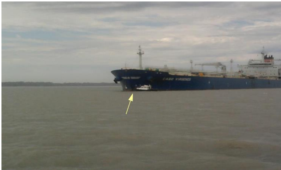
Ilustración 9. La lancha de apoyo engrilleta el mensajero al virador del buque.
